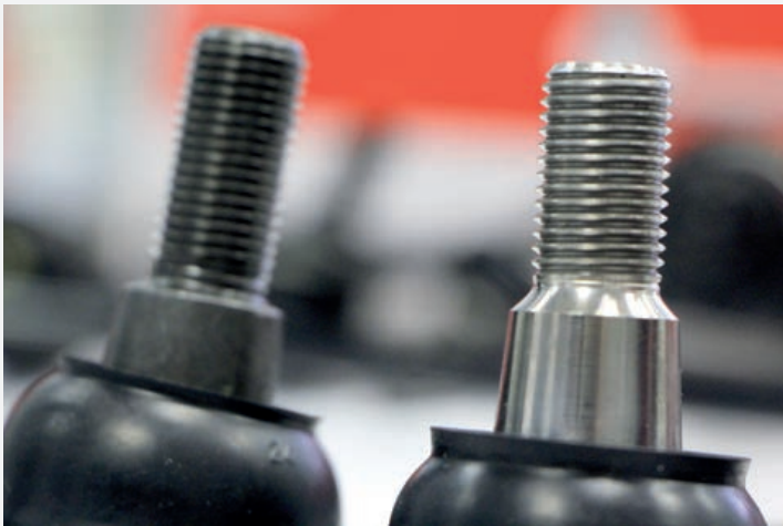
Шаровая опора CTR имеет палец темного цвета
