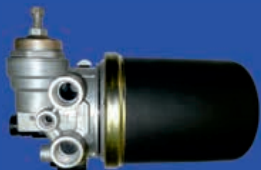
РЕГУЛЯТОР ДАВЛЕНИЯ С АДСОРБЕРОМ (8043.35.12.010)
