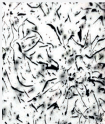
Текстура литья (под микроскопом со стократным увеличением). Графит выглядит как черные линии или вкрапления
