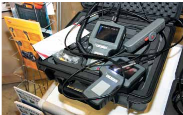
Для обнаружения отложений внутри агрегатов без их разборки применяются эндоскопы и бороскопы. Данные приборы позволят также вовремя обнаружить интенсивный (прогрессирующий) износ сетки хона на цилиндре и предпринять меры по замене масла или применения противозносной присадки.
