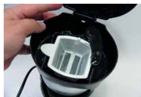
При неаннунтатном использовании станочка часто повреждается интегрированная в его дно сетка. Никаной ее ремонт не имеет смысла. Только замена детали.
