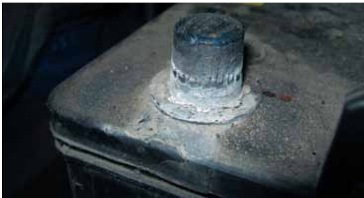
Грязь на крышке аккумуляторной батареи при намокании становится отличным проводником электрического тока. Замкнутые контакты являются причиной саморазряда аккумулятора.
