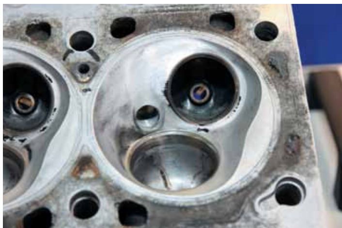
Самое опасное отложение лаков и смол, в том числе и от применения некачественных присадок в масла, на направляющих втулках клапанов. Если клапана прихватит, то от удара их тарелок о поршни стержни погнутся и герметичность стыка седло/фаска тарелки клапана нарушится.
