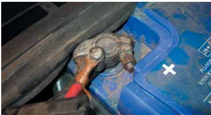
При подключении автономного жидкостного подогревателя непосредственно к аккумуляторной батарее необходимо обеспечить надежный контакт с его клеммами. Последние также должны быть исправны.
