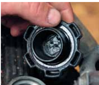
Неправильно подобранный пакет присадок, вводимых в моторные масла, может не только выпадать в виде осадка на дне картера двигателя, но и оседать в виде лаковых отложений на деталях мотора. На крышке классический «гуталин». Его происхождение поможет выявить спектральный анализ масла, но то, что машину снимут с гарантии, это точно.
