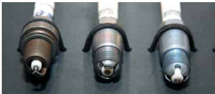
При работе мотора на топливе, в которое были введены присадки, оседающие на изоляторе свечей зажигания и вызывающие уход искры на массу, минуя контакты, неравномерная работа мотора обеспечена даже при использовании многоэлектродных свечей.
