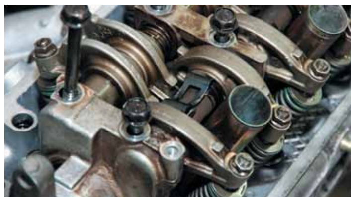
В контактной паре пятна коромысла/торец клапана, где возникают высокие контактные напряжения, работают строго определенные химические соединения (присадки), при нарушении хрупкого баланса их содержания в масле происходит интенсивный износ и «уход» регулировочных тепловых зазоров.
