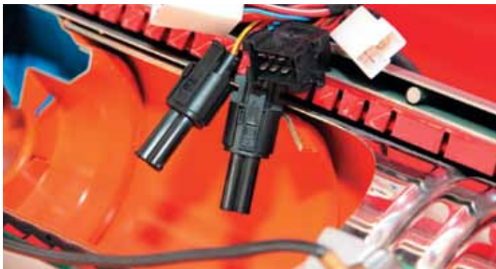
Несмотря на то, что контакты и электрические разъемы выполнены во влагозащитном исполнении, жидкостные автономные предпусковые подогреватели при погружении их в воду могут выйти из строя.
