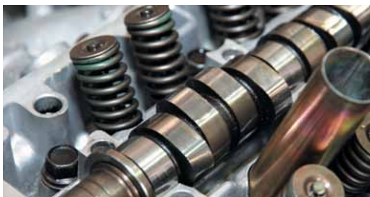
Верхневальные двигатели особенно требовательны к качеству масла, так как при холодном пуске нулачки работают в особо жестких, с ограниченной смазкой, условиях. Предотвратить износ закаленных, отбеленных (для чугуна) или цементованных (процесс цементации) поверхностей и позволяют противоизносные присадки.
