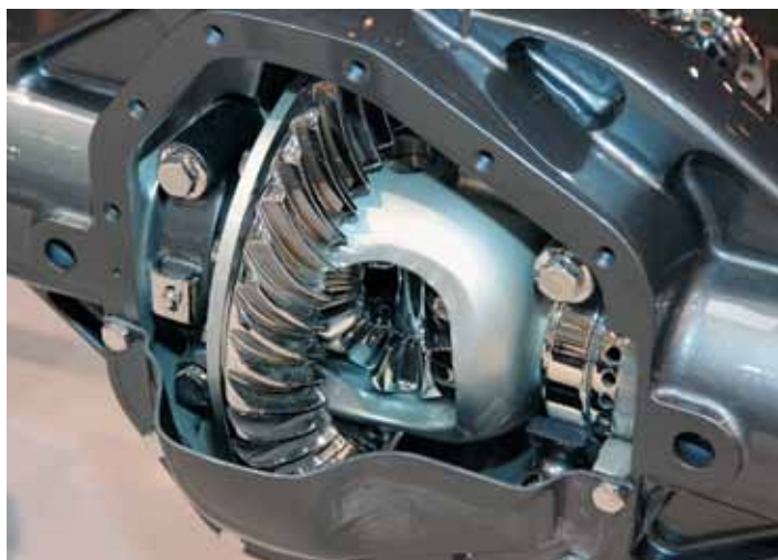
Зубья главной шестерни заднего моста или коробки (переднеприводный автомобиль) воспринимают большие контактные нагрузки. Если в момент их приложения, поверхности не разделяет смазка, происходит сваривание деталей и выкрашивание их поверхностей. В данном случае применение дополнительно присадки оправдано.
