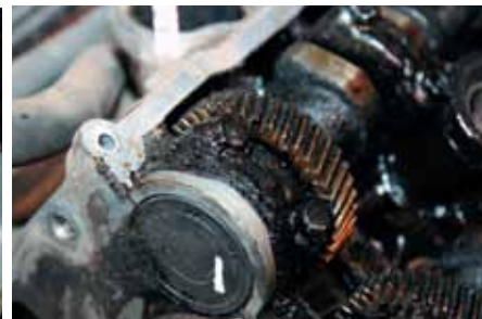
При работе мотора в экстремальных условиях, особенно на маслах, не обеспечивающих должный уровень защиты от износа, часто страдают шестерни привода газораспределительного механизма, что приводит к нарушению («плаванию») фаз газораспределения и неравномерной работе мотора. Эффе́нт наблюдается и на выносных силовых агрегатах V6, устанавливаемых на большое количество внедорожников и «паркетников».
