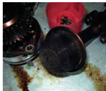
При взаимодействии моторного масла и присадки не исключено выпадение осадка в картере двигателя. Последний забивает маслоприемник и затрудняет подвод масла в магистраль. В результате масляного голодания «умирают» вкладыши коленчатого вала и оплавляются втулки турбокомпрессора. Итог – капитальный ремонт мотора.
