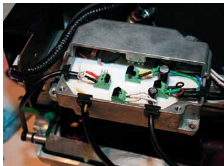
В данном случае плата системы управления не просто залита компаундом, но и размещается в герметичном корпусе из дюрала. Обратите внимание на то как выполнены входы питающих проводов, а также на метод герметизации стыка крышки с корпусом.
