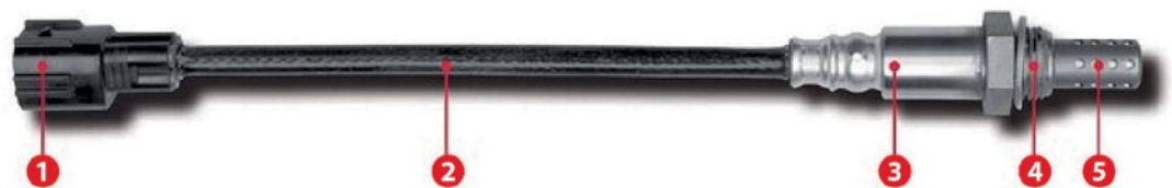
Кислородный датчик: 1 - электроразъем, 2 - кабель, 3 - корпус, 4 - резьба на корпусе для крепления датчика на выхлопной трубе, 5 - защитный кожух датчика
