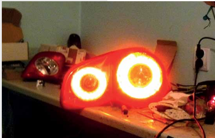
Использование LED-технологий обеспечивает мгновенную связь между нажатием на педаль тормоза и срабатыванием стоп-сигналов. VW Passat B6
