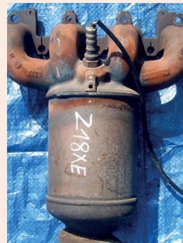
Компактный вариант расположения выпускного коллектора, каталитического нейтрализатора и кислородного датчика
