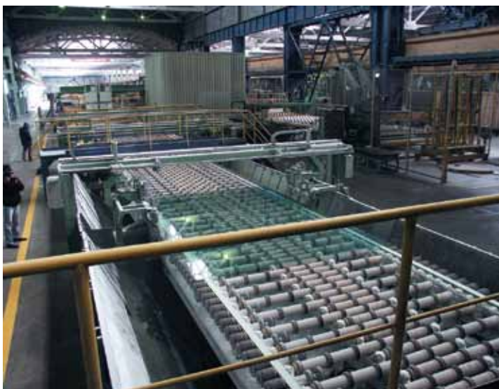
Флоат-технология позволяет производить огромное количество листового стекла.
