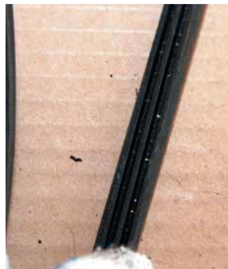
Твердые частички, попадая на ремень, буквально вбиваются в него. По этой причине в особо пыльных условиях эксплуатации ремня нужно менять раньше положенного срока.
