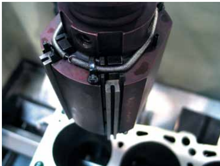
Только качественные головки способны обеспечить правильную геометрию цилиндра. Любое отклонение приведет к ускоренному износу поршня и его колец.
