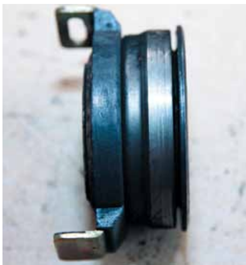
Даже после пробега в 100 000 км подшипник не имеет большого люфта, о чем красноречиво говорит равномерный зазор между нажимной частью и внешним корпусом. Расчетный ресурс данного узла составляет как минимум 150 000 км.
