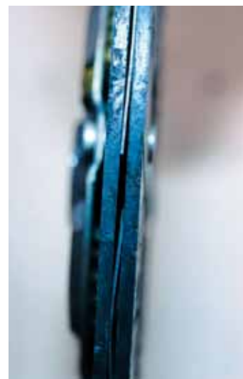
Обратите внимание на то, что износ фрикционных накладок равномерный, а лепестковые пружины ведомого диска сохранили свою геометрию и эффективно гасят ударные нагрузки.
