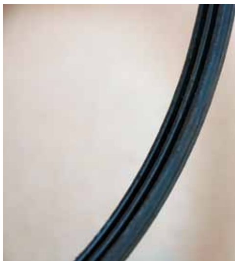
Клиновой ремень изнашивается по боковым поверхностям, так как передает крутящий момент благодаря заклиниванию в шниве. При сильном износе поверхностей натягивать ремень бесполезно, все равно будет проскальзывать. На фото четко видны следы износа боковых поверхностей.
