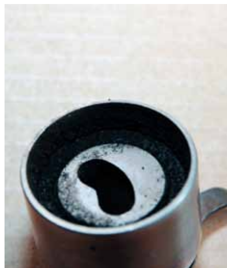
Продукты износа привода и проникающая под закрывающий его конус пыль оседают на уплотнении подшипника ролика, поэтому оно должно быть герметичным и надежным, в противном случае преждевременный износ подшипника гарантирован.
