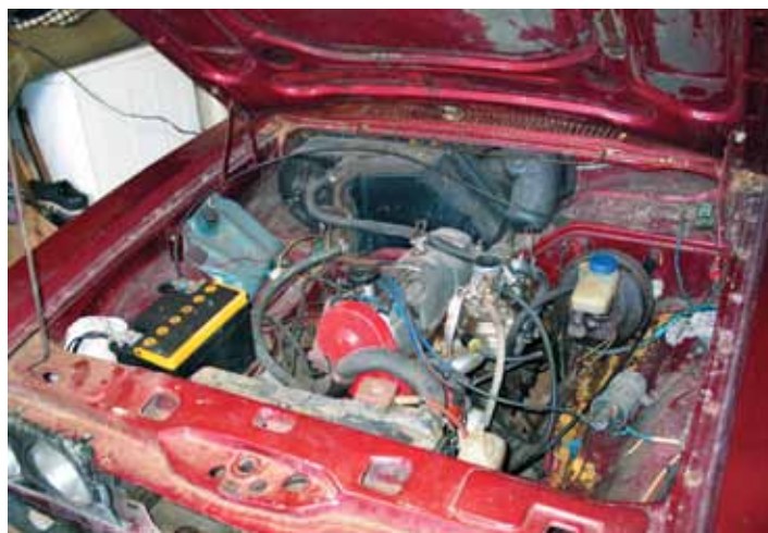
Моторный отсек автомобиля Форд «Картина». На брызговине, слева по ходу движения смонтирована классическая катушка зажигания в металлическом корпусе.
