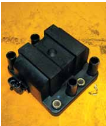
Катушка зажигания автомобиля Лада «Калина». Таной модуль обслуживает все четыре цилиндра.
