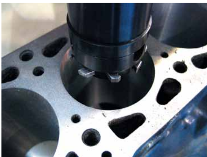
Чтобы новые поршни исправно служили, необходимое условие – расхождение блока цилиндров с соблюдением перпендикулярности осей цилиндров и коленчатого вала. Для этого важно не только иметь современное рассточное оборудование, но и правильно базировать обрабатываемую деталь.
