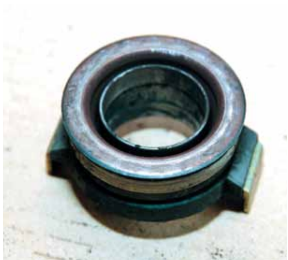
А это тот самый выжимной подшипник, который сточил ламели нажимного диска («норзины»). Заметьте, что его контактная поверхность хоть и имеет характерные для перегрева цвета побежалости, но сохранила свои геометрические размеры. Это говорит о том, что примененная при изготовлении узла сталь была высокого качества.
