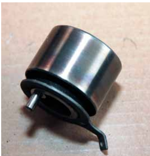
При замене приводного ремня обязательно меняйте и натяжной ролик. Приобретая запасную часть, не экономьте, так как от этого будет зависеть надежность работы привода.
