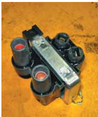
Катушка зажигания автомобиля «Волга» с мотором производства Заволжского Моторного Завода ЗМЗ – 406. Для четырехцилиндрового мотора требуется два таких модуля – каждый на два цилиндра.
