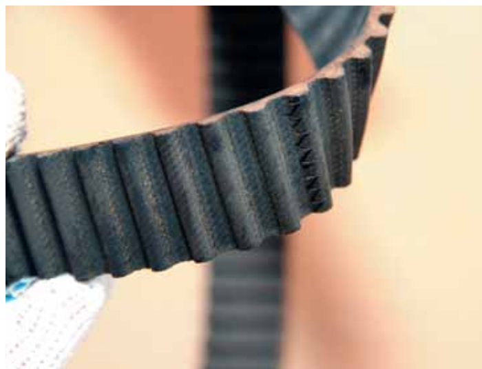
Порванные нити армирующего слоя – начало разрушения ремня. Вовремя произведенная замена компонентов привода спасла мотор от встречи поршней с клапанами.
