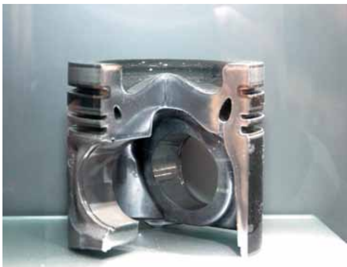
Обратите внимание на темные места в зоне расположения первого компрессионного кольца. Это признак того, что данные участки детали были усилены технологией лазерного легирования, в ходе которой происходит «переплавка» металла с внесением определенных химических элементов.
