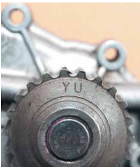
Ресурс зубчатого приводного ремня во многом зависит от качества изготовления шнивов. Чем точнее их форма и чище обработка, тем меньше износ.
