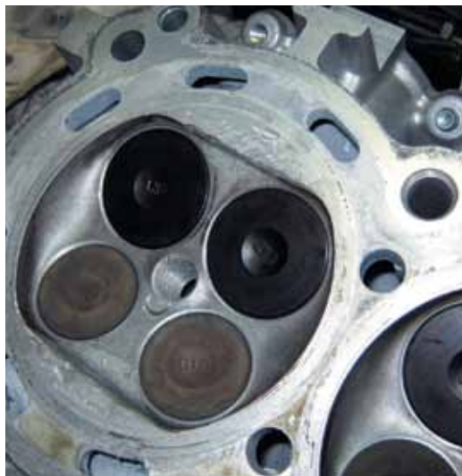
Четырехклапанные головки блока цилиндров требуют применения более прочных и надежных приводных ремней. Разрушение зубчатого ремня грозит капитальным ремонтом ДВС.
