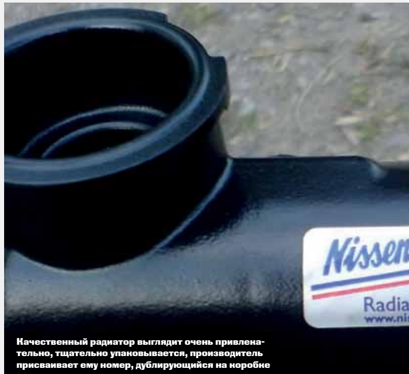
Комбинированный радиатор, имеются и алюминиевые, и пластмассовые детали
