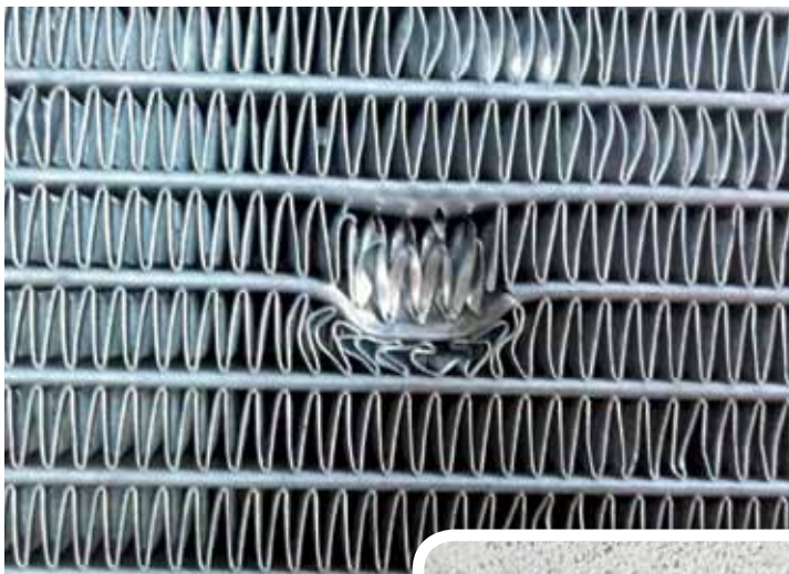
Наиболее часто радиаторы выходят из строя из-за физического воздействия на конструкцию радиатора
