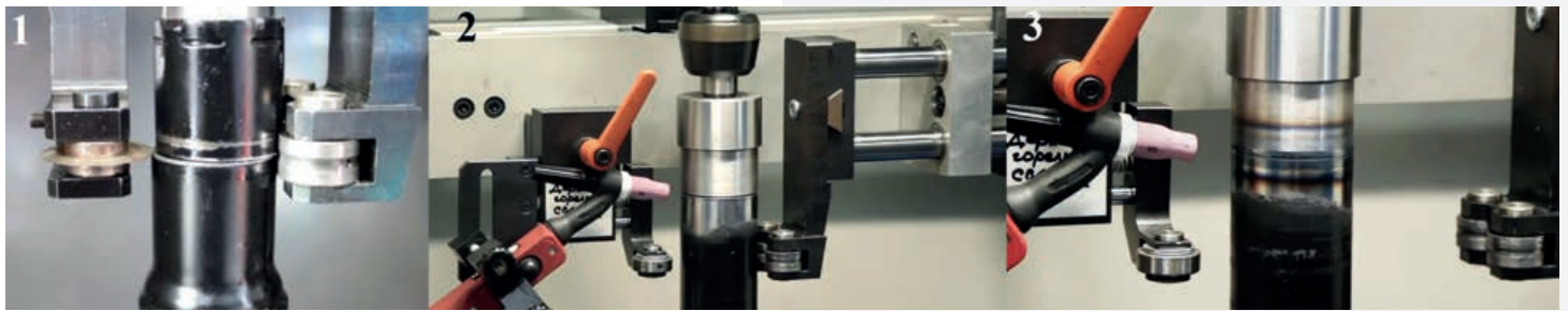
На стенде Emmetec Mangusta 99-971 можно отрезать верхнюю часть неразборного рабочего цилиндра (1), выставить по оси штангер с внутренней резьбой (2) и аннуратно приварить (3)
