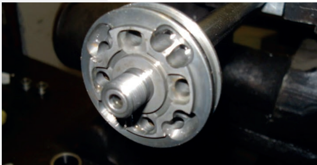
Поршень амортизатора. С помощью замен и манипуляций с шайбами поршня можно менять параметры амортизатора
