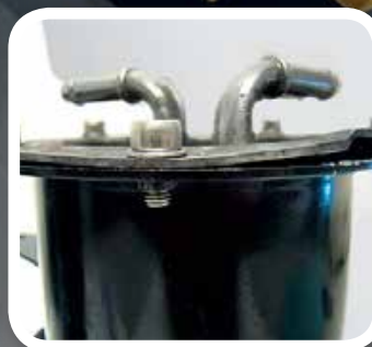
Рис 5. Деформированная вследствие неправильного монтажа и демонтажа крышка корпуса топливного фильтра
