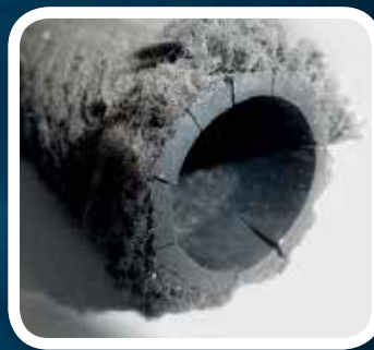
Рис 1. Потрескавшийся вследствие потери эластичности топливный трубопровод - причина появления побочного воздуха в системе
