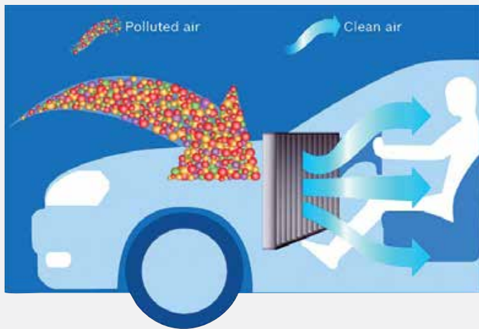
Воздух, окружающий автомобиль на дороге, содержит в среднем 0,0003...1,5 г/м³ пыли. Для лучших фильтров уровень фильтрации составляет 99,9%, но, к сожалению, такое качество очистки могут обеспечивать фильтры только самых известных производителей: Mahle, Mann+Hummel, Baldwin Filters, Sogefi Filtration, Hengst и некоторых других
