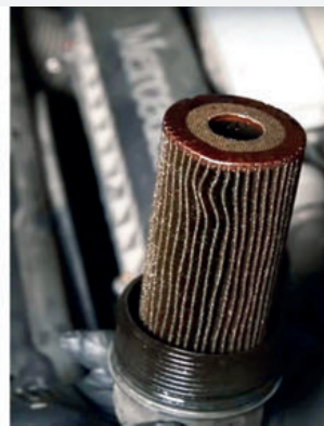
Разборные фильтры со сменным патроном разбирают, используя спецключ
