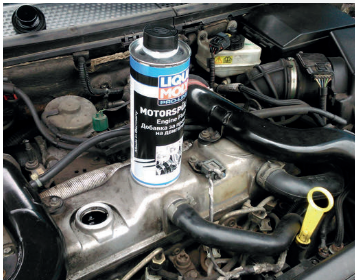
Некоторые моющие добавки вымывают отложения очень агрессивно, возникают определенные реакции между компонентами заливаемого химиката и маслом в двигателе. После использования таких промывок могут потечь сальники, забиться масляные трубопроводы
