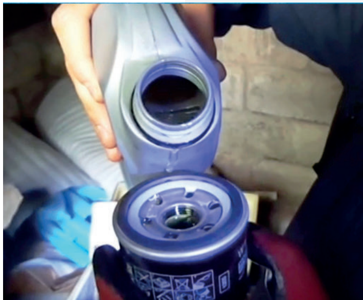
Перед установкой нового фильтра рекомендуют заполнить его маслом, чтобы двигатель как можно меньше работал без смазки
