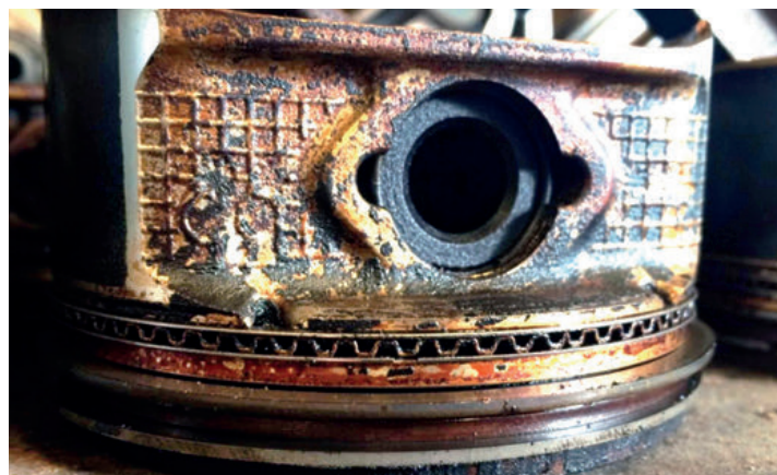
Отложения на поршнях, свечах зажигания, клапанах, поршневых кольцах появляются при агрессивном стиле вождения, а также при использовании моторного масла низкого качества, не соответствующего характеристикам двигателя, при несоблюдении сроков замены
