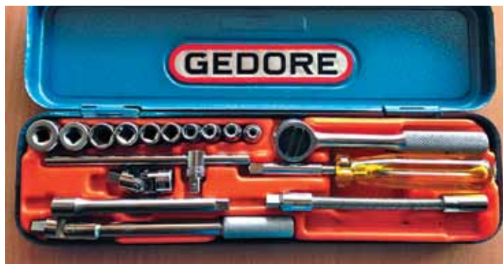
Торцевые головки, воротки, удлиннители - эти инструменты от Gedore существенно облегчают выполнение ремонтных процессов.
