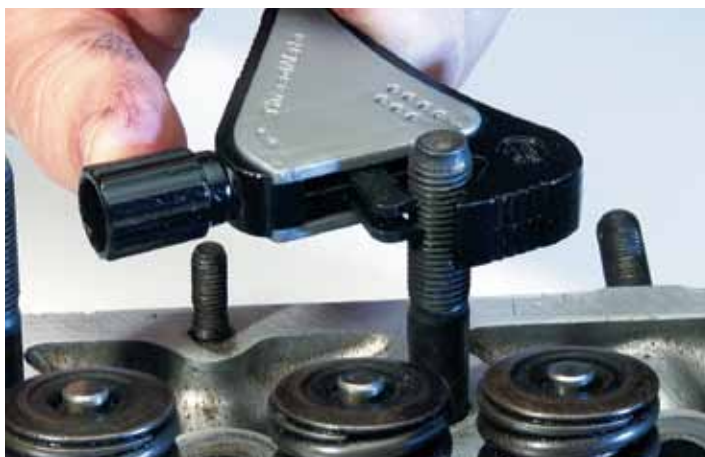
Специальный ключ для закручивания шпилек от компании Wright tools
