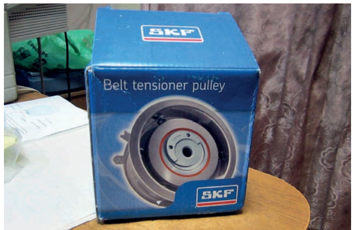
Ролик натяжителя обязательно нужно менять вместе с ремнем
