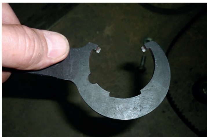
Для натяжки ролика ГРМ понадобится специальный ключ, хотя многие делают его самостоятельно
