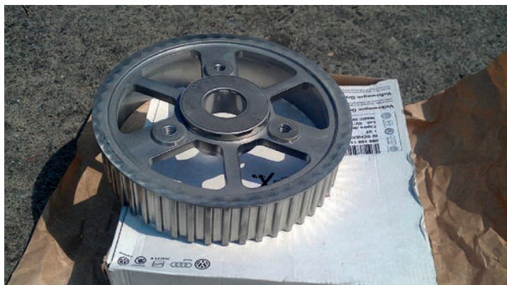
При износе шестерни-шкива распредвала необходимо заменить его новым, чтобы зацепление ремня и шкива было максимально полным
