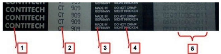
Рис. 4 Маркировка на ремне ГРМ Continental ContiTech CT909: 1 - наименование производителя; 2 - каталожный номер; 3 - страна производства; 4 - предупреждение: «Не сгибать» на английском и немецком языках; 5 - дата производства в формате «ддммгггг»
