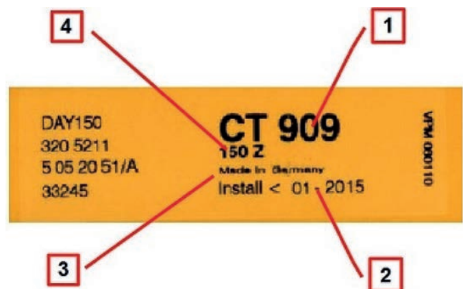
Рис. 5 Маркировка на упаковке ремня ГРМ Continental ContiTech CT909 1 - номер детали по каталогу; 2 - дата, после которой установка и эксплуатация ремня запрещена; 3 - страна производства
