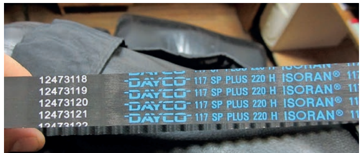
По каталогу, с учетом года выпуска автомобиля и модели двигателя, выбираем ремень, не забывая проверить дату выпуска на упаковке или самом ремне
