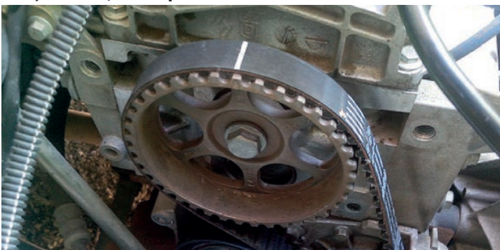
При замене ремня крайне важно, чтобы метка на ремне совпадала с метками на шестерне и блоке
