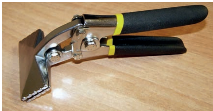
Ручки специальных клещей для гибки листового металла покрываются нескользящим упругим полимерным покрытием, форма ручек позволяет максимально использовать приложенное усилие руки при выполнении рабочих действий
