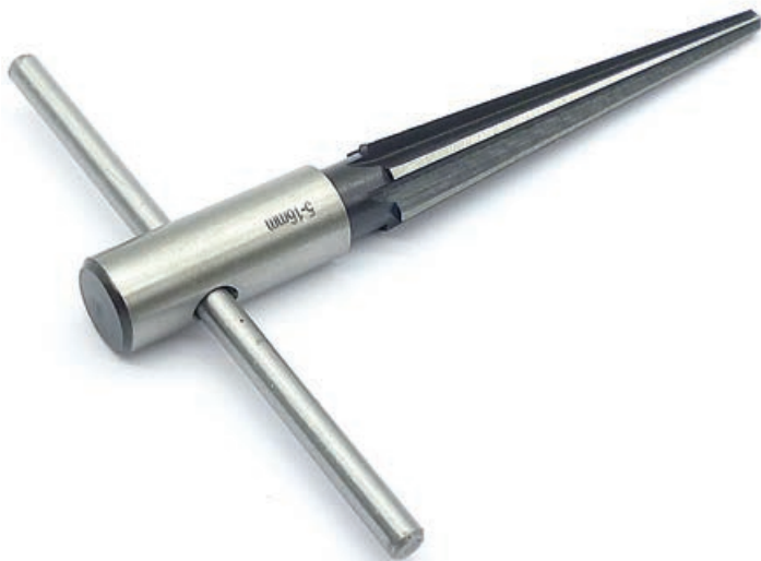
Коническая ручная развертка 5–16 мм, изготовленная из инструментальной стали, позволяет вручную увеличивать диаметр отверстия в листовом металле
