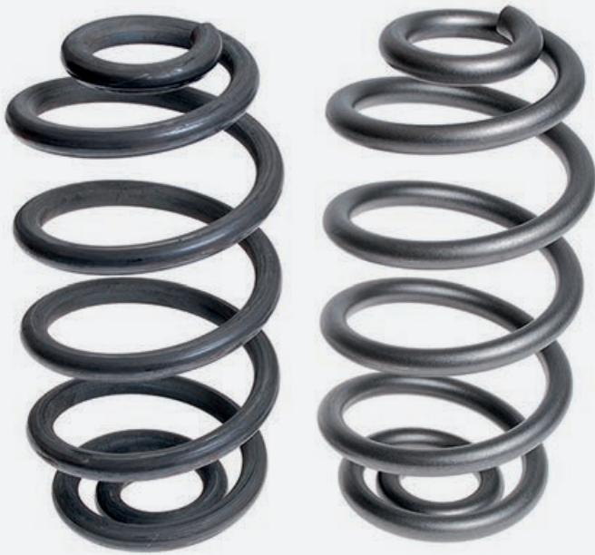
Винтовая пружина до (справа) и после (слева) дробеструйной обработки. Улучшенные показатели усталости материала и оптимальная поверхность для покраски
