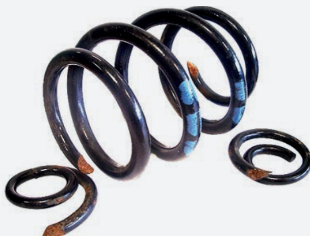
Оригинальная пружина с переменным поперечным сечением с преждевременной поломкой на обеих сторонах проволоки
