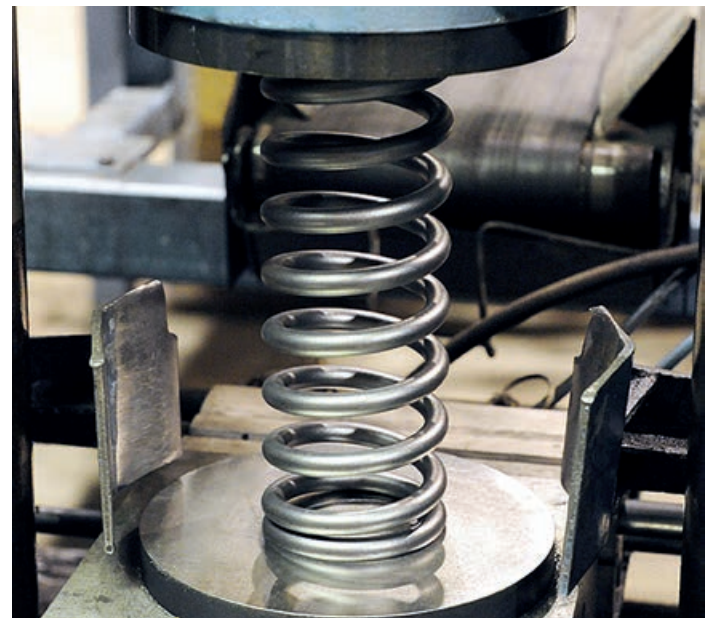
Осадка включает в себя полное сжатие пружины для повышения положительного остаточного напряжения
